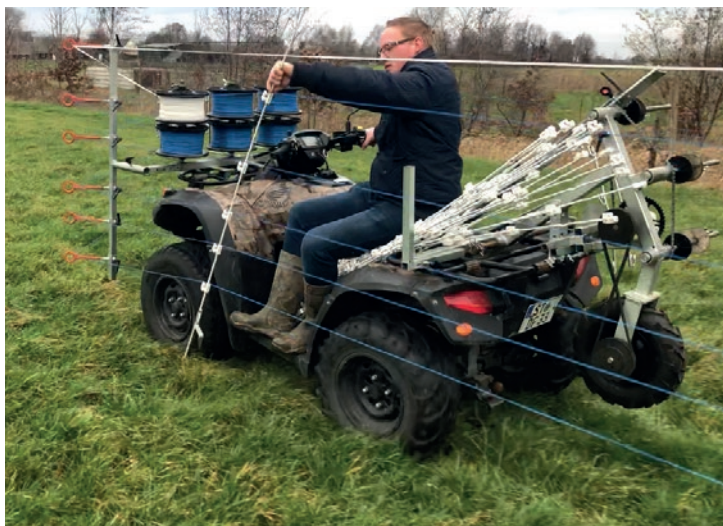
Demonstratie meerdraads oprolsysteem, hier nog met paaltjes van ca. 1,5 meter in plaats van 1,2 meter.
